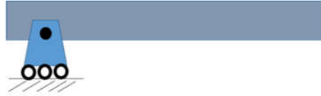
الشكل (3) : مقطع بالمسند المتحرك
