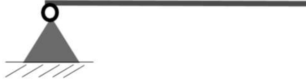
الشكل (2) : طريقة رسم المسند الثابت
