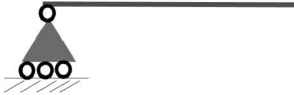
الشكل (4) : طريقة رسم المسند المتحرك
